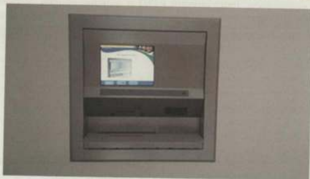
Figura 26. Stații self-check de autoarestituire de tip "throw & go", montate pe peretele exterior al bibliotecii pentru a asigura servicii tip 24/7 http://www.tech-logic.com/products/ultrasort-with-throw-go-book-drop
