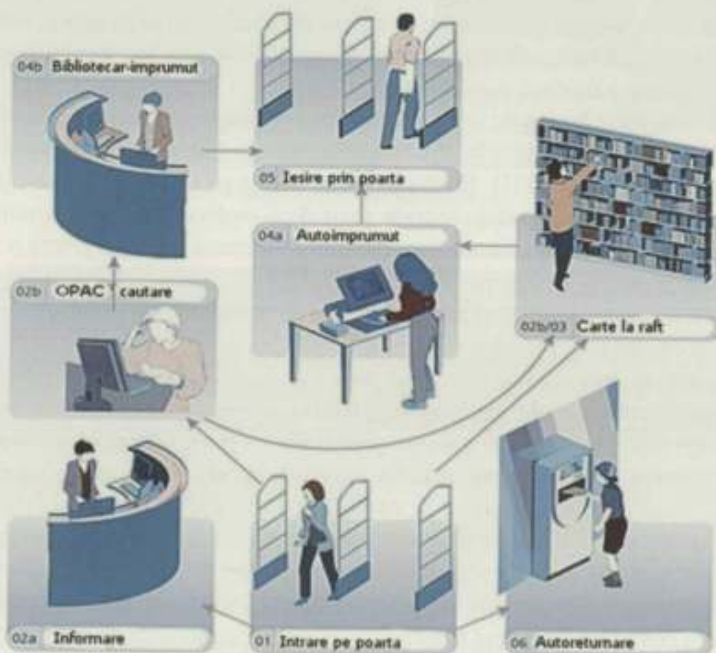
Figura 27. Fluxul cititorilor și circulația cărților în Sistemul RFID http://www.lib.ugal.ro/sipteh/ro/images/pdf/rst-i.pdf
