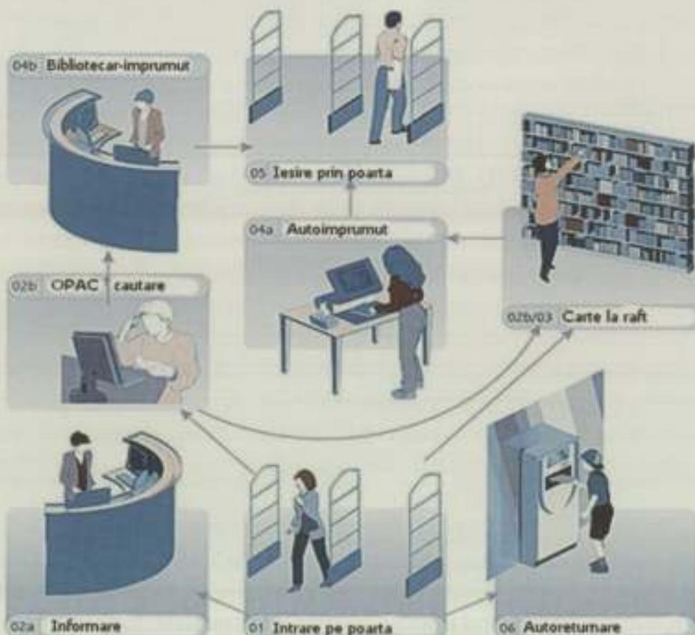
Figura 27. Fluxul cititorilor și circulația cărților în Sistemul RFID
